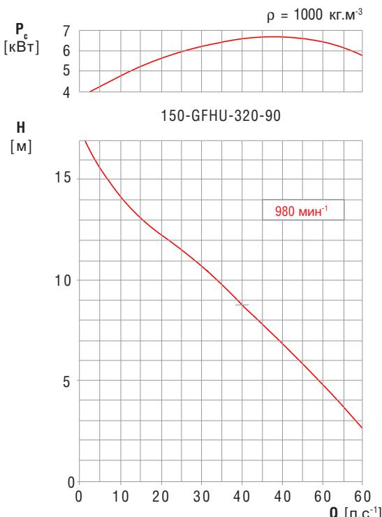
Пониженное число оборотов и слишком небольшой напор H предназначают этот тип насоса или для длительного режима работы или применения его для перекачивания. Он находит применение особенно на станциях очистки сточных вод для рециркуляции шламов в метантенках/септиках, для вычерпывания шламостойников в промышленности и сельском хозяйстве, для подъема уровня из ниже расположенных сборников коллекторов на уровень естественных стоковых сетей каскадных систем, и т. д.
