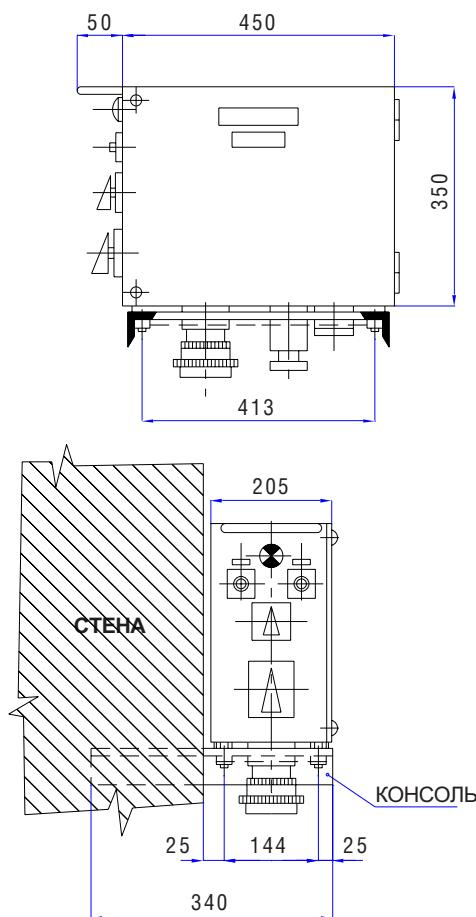
Встроенные размеры обоих типорядов инструментных шкафов являются совпадающим.
