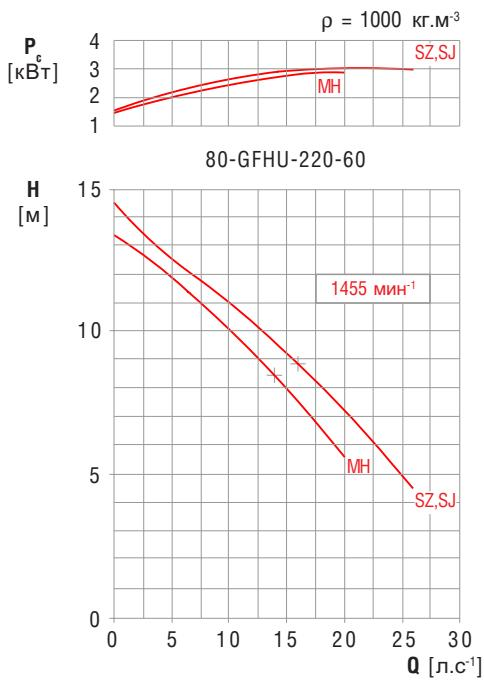
Этот наименьший типоразмер предназначенный для насосных станций работающих в промышленных установках, на небольших станциях очистки сточных вод, и т. д. Широко применяется он особенно в портативном варианте выполнения „МН“, в качестве мобильной насосной установки, для очистки вторичного отстойника и отстойного бассейна, дождевого бьефа и поводковых колодцев, далее при откачивании просачиваемой воды из арматурных шахт и в строительстве при перекачивании густых шламов из траншей.
